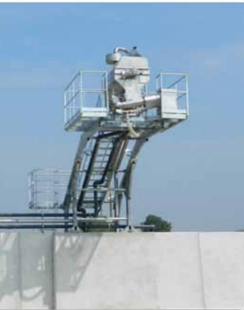
Vista del separatore compattatore che permette la dissociazione del digestato tra la frazione solida e quella liquida; tale apparecchiatura permette la rimozione di corpi solidi fino ad una dimensione di 300 μm.
